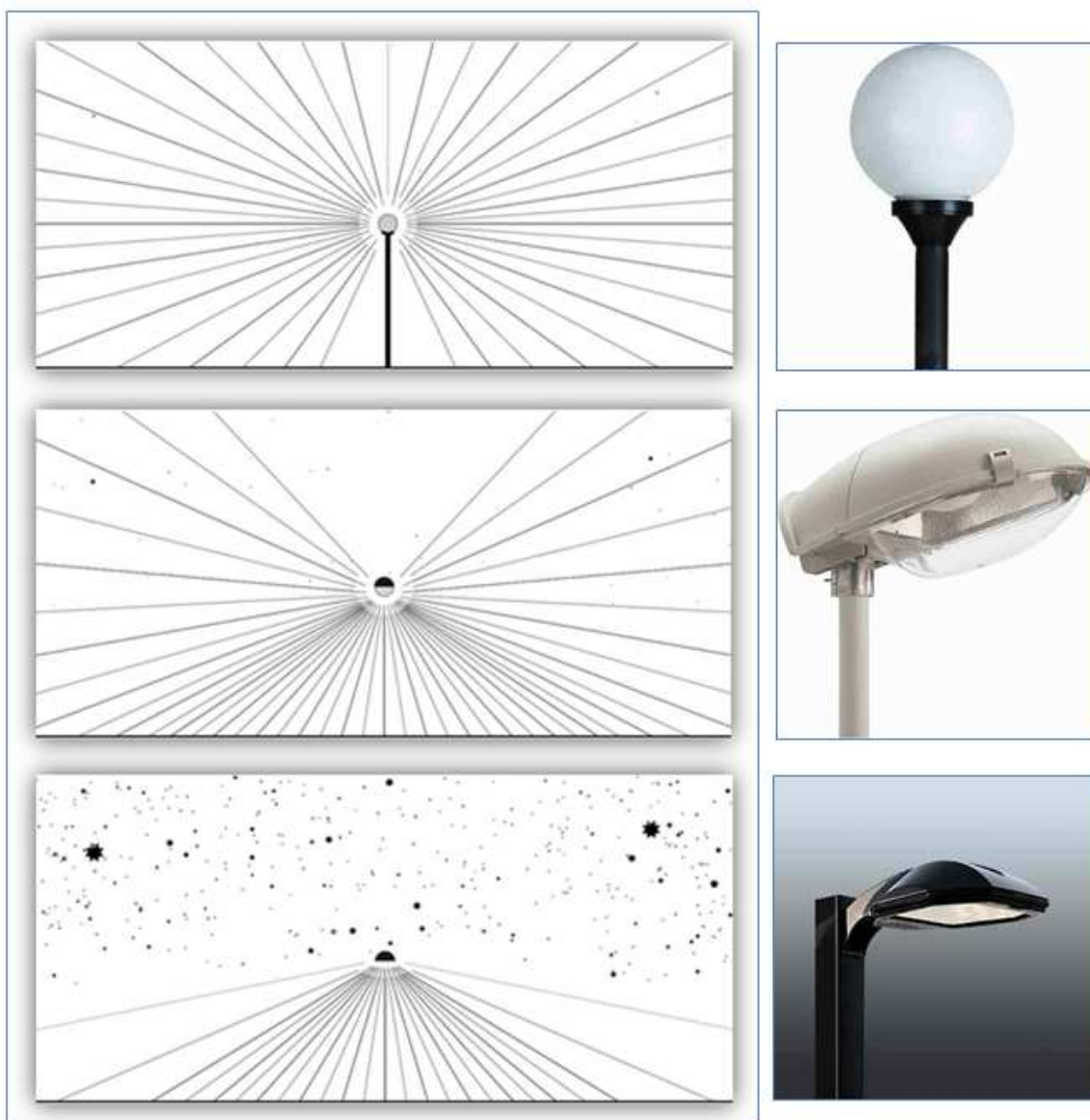
Rysunek 2 Trzy typy opraw oświetleniowych: z kloszem sferycznym – wysoki ULOR (górną), z kloszem wypukłym – znaczący ULOR (środek), z kloszem płaskim – ULOR=0% (dół). W prawej kolumnie przykładowe oprawy tych trzech typów. Dla oświetlenia zewnętrznego IA UWr dopuszczalny jest tylko typ trzeci (ULOR=0%).
